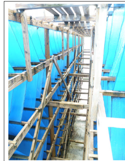
噴撒した海水は、ネットを伝わってどんどんカン水施設下部へ落 ちていきます。この間に風と太陽熱によって、水分が徐々に蒸発 していきます。
