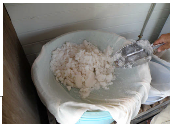
脱水した塩の結晶を篩にかけて、大きい粒を取除いていきます。
